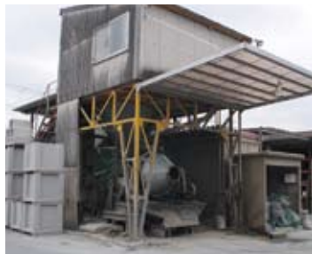
同社のコンクリートミキサー。コンクリート製品の製造を中核として、さらなる技術開発を続けていく
